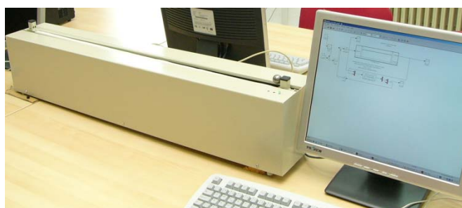
Obr. 5.2. Foto výukového modelu kuličky na tyči
